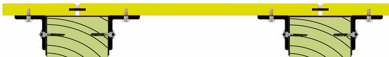
Balkonbodemplaat op houten draagbalken blind bevestigd (geschroefd)
